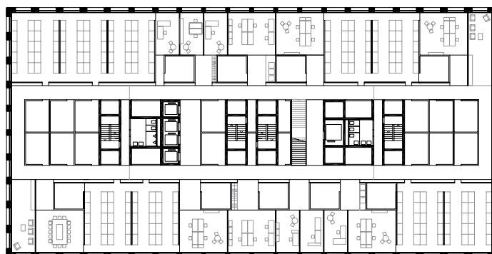
05+06 «Biozentrum»: Monolith mit gelochter Fassade; funktionaler Grundriss mit zentralem Kern (Bild + Plan: Christ & Gantenbein Architects)
